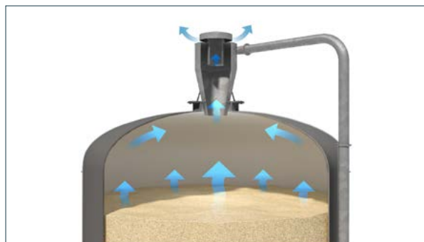
Optimal udluftning via udluftningsrør med et stort areal minimerer kondens dannelse. Derved undgås dårlig foderhygiejne.
